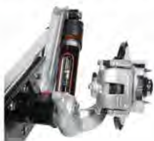
Suspension arrière ALC : position constante quelle que soit la charge
